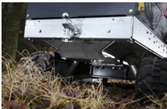
Distancia al suelo de 250 mm, fácil mantenimiento y protección de manguitos reforzada
